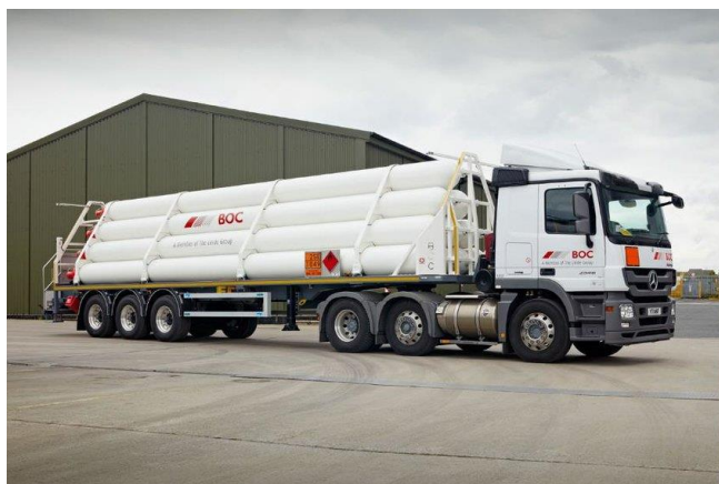
Obr. 49 - Příklad vodíkového traileru se svazkem deseti ocelových tlakových lahví
