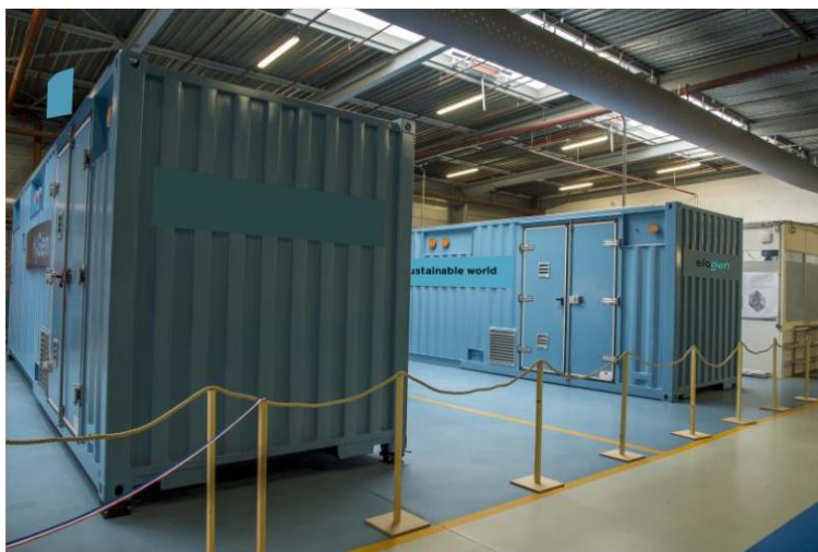
Obr. 41 - Elektrolyzér Elogen ELYTE 260 [32]
